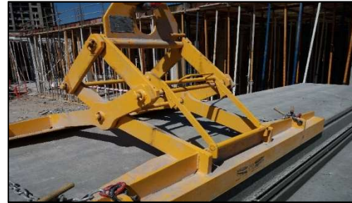
Pinza de apriete para elevación de placas alveolares
